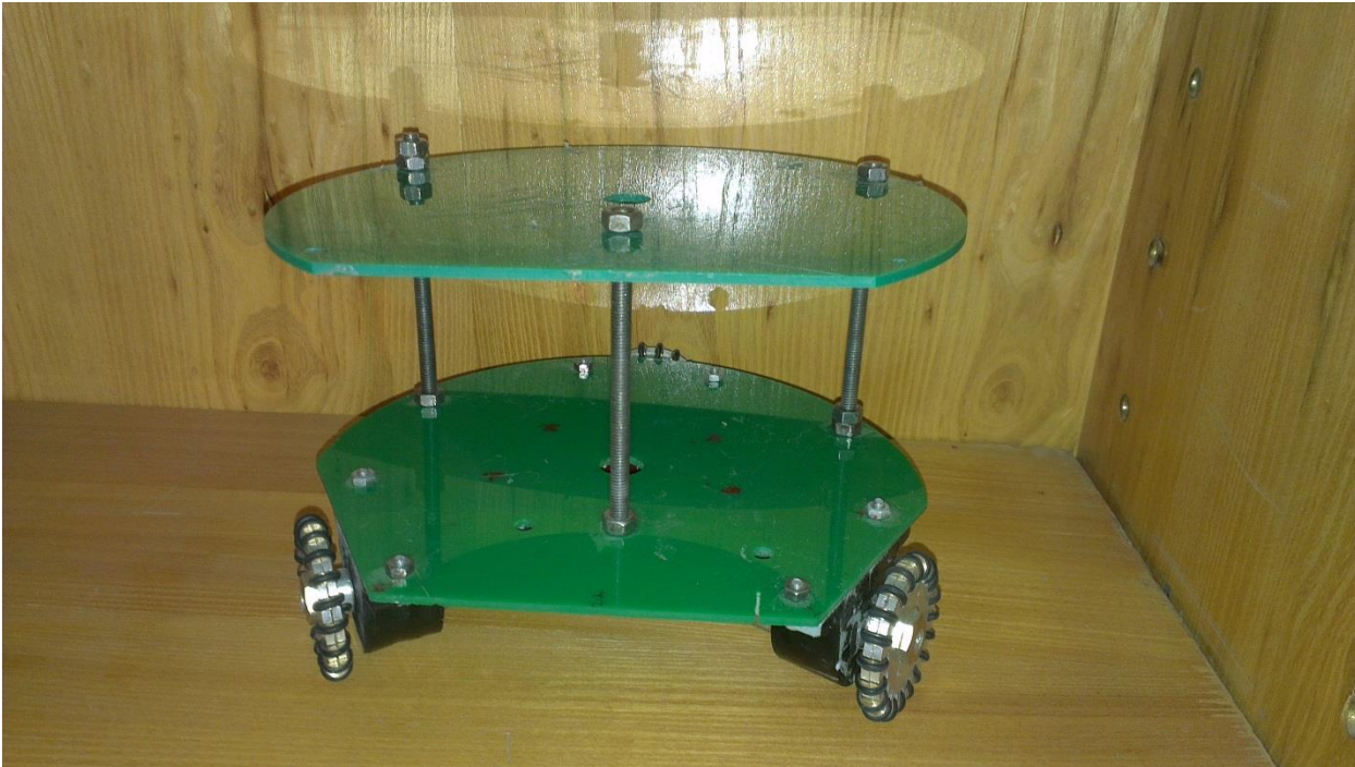
شکل ۲-۱۰ نمونه‌ی ساخته شده ایده شماره ۲ از نمای روبرو، این روبات با سه چرخ خورشیدی که دارای زاویه‌ی ۱۲۰ درجه با یکدیگر هستند مدل می‌شود. این چرخ‌ها حرکت روبات را در دستگاه مختصات استوانه‌ای مدل سازی می‌کنند.
